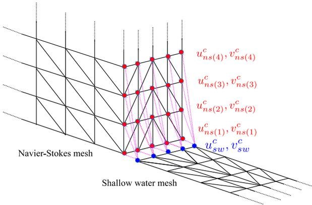
図-3 適合メッシュ間の流速の MPC 条件
