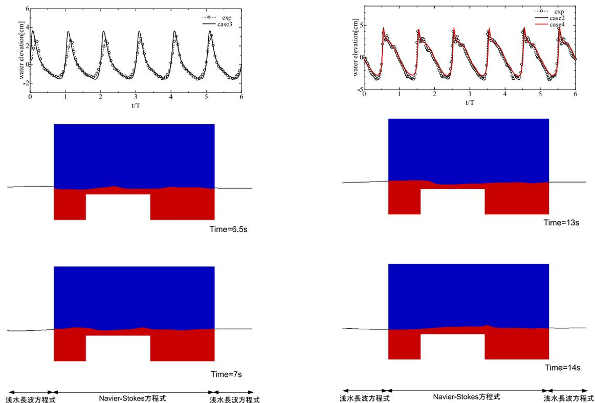
図-11 case3 における実験値との比較と各時刻における水面形状 図-12 case4 における実験値との比較と各時刻における水面形状
